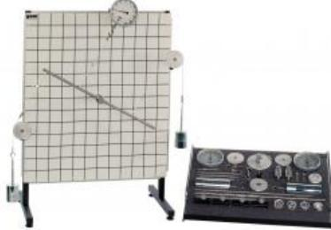
**Équilibre des forces, des moments, de la décomposition des forces, du principe de levier**
