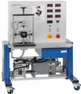
**TM 290 Palier lisse avec lubrification hydrodynamique**
