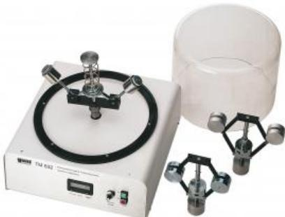
Les régulateurs centrifuges utilisent les propriétés de la force centrifuge pour réguler la vitesse de rotation d'une machine.
