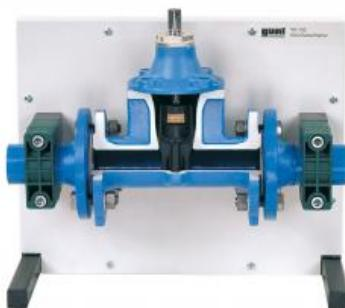
Véritable robinet-vanne ovale à sièges obliques transformée en modèle en coupe. Avec raccords bridés, montée sur un panneau de démonstration. Le fonctionnement de toutes les pièces mobiles est conservé.
