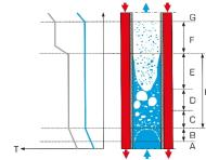
Lors de la production de vapeur, le milieu à évaporer passe par différentes formes d'écoulement en fonction de la zone de transfert de chaleur.
