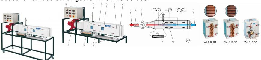
Le banc d'essai est constitué d'un canal isolé, à travers lequel de l'air est aspiré à l'aide d'un ventilateur. Différents éléments échangeurs de chaleur peuvent être placés dans le canal d'air:
