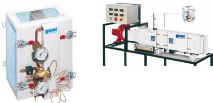
L'échangeur de chaleur WL 312.03 permet de réaliser des études sur un évaporateur de réfrigérant dans le banc d'essai WL 312.
