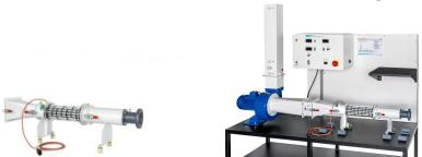
L'accessoire WL 314.02 permet d'étendre les possibilités du WL 314 à la thématique: transfert de chaleur convectif avec un écoulement mélangeé.
