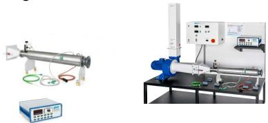
L'accessoire WL 314.03 permet d'étendre les possibilités d'essai du WL 314 à la thématique: transfert de chaleur convectif à l'intérieur d'un tube.
