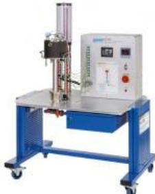
**WL 900 Banc d'essai de conductivité thermique linéaires de divers éprouvettes (Réf. 060.90000)**
