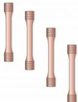
Ce jeu d'éprouvettes de traction est disponible comme accessoire pour la machine d'essai universelle WP 300. Il comprend des échantillons de traction en cuivre (E-Cu).
