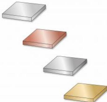
**WP 300.03 4 Eprouvettes pour essai dureté Brinell, aluminium, cuivre, acier, laiton (Réf. 020.300)**
