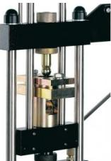
Ce dispositif complémentaire à la machine d'essai universelle WP 300 permet d'effectuer des essais d'emboutissage pour l'évaluation des propriétés des tôles fines.
