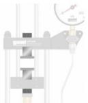
Ce jeu de plaques de compression, disponible en accessoire pour l'appareil d'essai WP 300, permet de réaliser des essais de compression.
