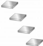
Ce jeu d'échantillons métalliques est disponible comme accessoire pour la machine d'essai universelle WP 300. Les échantillons sont de forme carrée et sont prévus pour la réalisation des essais de dureté suivant Brinell. Le jeu comprend quatre échantillons en acier (9SMn28).
