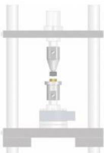
Cet accessoire, conçu pour l'appareil dessai WP 310, permet de réaliser des essais de dureté Brinell. Cette installation dessai est composée dun dispositif avec une bille en acier trempé comme corps déprouvette et dune plaque de compression pour le logement de léprouvette. Ce dispositif est inséré dans la traverse supérieure de l'appareil dessai WP 310 et la plaque de compression dans la traverse inférieure.
