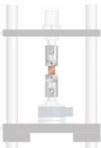
Cet accessoire, conçu pour l'appareil dessai WP 310, permet de réaliser des essais de cisaillement à double section.
