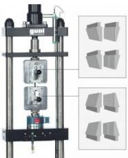
Cet accessoire, conçu pour l'appareil de test WP 310, permet de réaliser des essais de traction sur des éprouvettes plates ou rondes.
