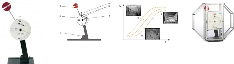
Dans le contrôle qualité industriel, l'essai de résilience est un essai très répandu; il permet de déterminer rapidement et simplement des valeurs caractéristiques pour l'évaluation de matériaux ou de composants. Le banc d'essai WP 410 est un mouton pendule solide suivant la DIN EN ISO 148-1, qui a été conçu pour la réalisation d'essais de résilience Charpy.
