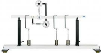
Application de la méthode des sections pour déterminer les réactions internes de la poutre
