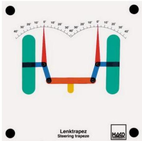
Braquage plus important de la roue intérieure au virage, angle de différence de voie lisible.
