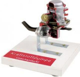
Fonctionnement de la membrane, du poussoir et des soupapes.
