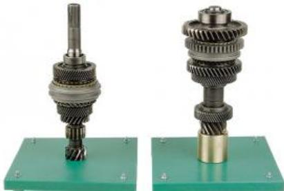
Arbre principal tronqué, monté sur support, pour le démontage et le montage de 2 vitesses chacun, outils inclus. L'unité de synchronisation a été préparée de manière à pouvoir être montée sans extracteur ni presse. Particulièrement adapté à la réalisation d'une procédure de montage. Les vitesses sont faciles à passer.
