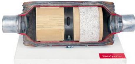
Boîtier métallique d'un nouveau convertisseur catalytique découpé pour montrer les deux corps en céramique. De plus, un nid d'abeilles coupé ouvre le tube à l'intérieur du boîtier en céramique.
