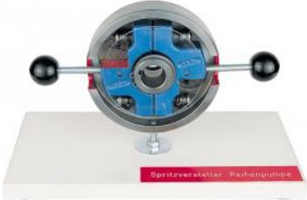
En tirant sur les poignets, les masselottes sont tirées vers l'extérieur à l'encontre de la force du ressort et règlent la sortie par l'intermédiaire d'excentriques dans le sens de "l'injection antérieure".
