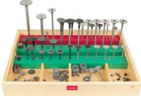
Fabrication de soupapes, du flan à la pièce finie
