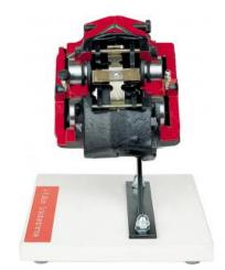
Etrier pour frein à disque, fixe avec 4 pistons en coupe
