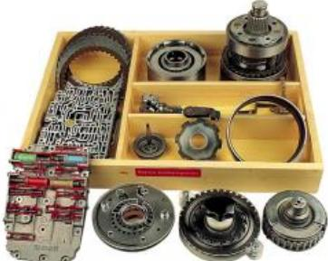
Contient les composants de transmission automatique les plus importants (certaines pièces sont en coupes). Commande hydraulique avec soupape de changement de vitesse, régulateur centrifuge, roue libre, pompe à engrenage interne, train épicycloïdal complet (facilement démontable), bande de frein, 2 raccords hydrauliques, position de stationnement avec cliquet, jeu de disques.
