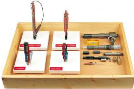
Quatre injecteur diesel (Nos 1173 à 1176) montées sur support.
