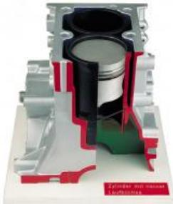
Le bloc-cylindres a été découpé de manière à ce que les chemises humides soient bien visibles. Les canaux de refroidissement (peints en bleu foncé) et l'étanchéité des chemises sont bien visibles.
