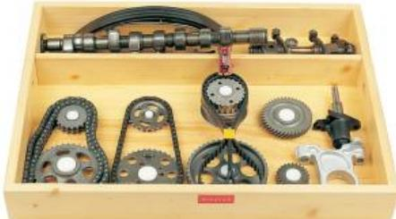
Distribution par arbre à cames au moyen de: engrenages cylindriques, chaînes simples et doubles, courroie crantée.
