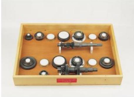
Boîte de vitesses à quatre rapports avec arbre d'entraînement et arbre de sortie pour traction avant (boîte de vitesses à axes décalés)
