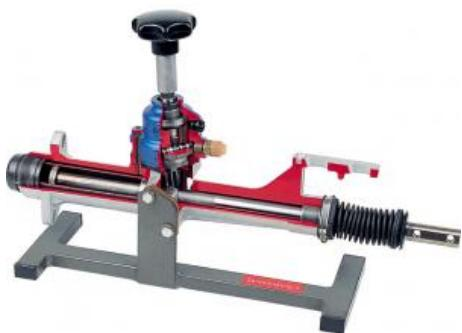
Séquence de mouvement dans l'appareil à gouverner, rapport de transmission dans le système de direction.
