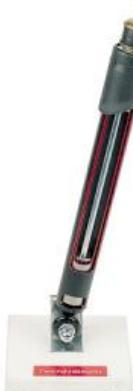
L'amortisseur a été découpé de manière à ce que l'on puisse bien voir le tube intérieur et extérieur avec la soupape de fond et le piston.
