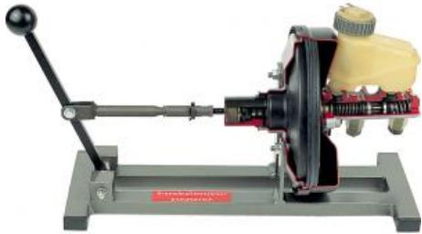
En appuyant sur le levier, on peut voir la soupape extérieure s'ouvrir.
