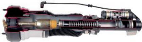
Dans la classe S de Daimler-Benz, 4 suspensions sont utilisées sur les essieux avant et arrière en tant qu'éléments fonctionnels de l'Airmatic.
