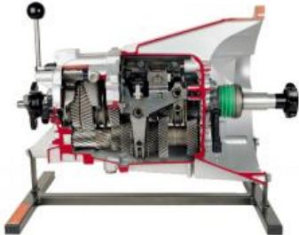
Cette nouvelle construction est une boîte de vitesses à trois arbres coaxiaux avec 6 vitesses avant et une vitesse arrière synchronisée.
