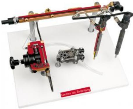
Sur ce modèle, les éléments les plus importants de l'unité d'injection à rampe commune peuvent être configurés et connectés aux conduites de carburant.
