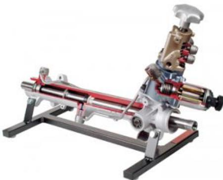
Ce système comprend essentiellement une direction à crémaillère, une transmission planétaire, un moteur électrique, des capteurs et une unité de contrôle.
