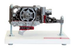
Les nouveaux moteurs à 6 et 8 cylindres en V de Mercedes Benz utilisent une pompe à huile à palettes nouvellement mise au point avec une régulation de la quantité en fonction de la demande et deux niveaux de pression contrôlés par carte.
