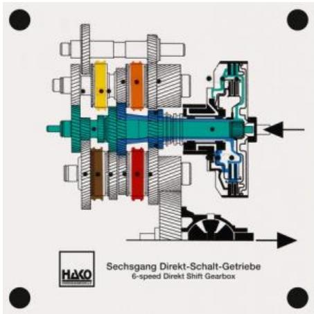
Les avantages de la boîte manuelle ont été idéalement combinés à ceux de la boîte automatique. Voici ce que l'on peut voir : Passage des 6 vitesses avant et de la marche arrière. Commutation de l'embrayage intérieur et extérieur.
