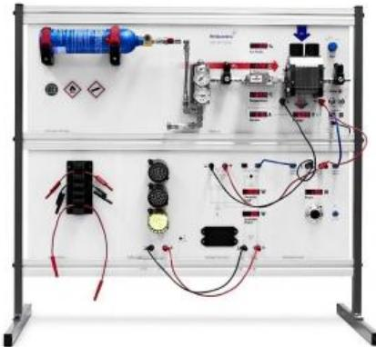
**Fuel Cell Trainer FCT, Pile combustible hydrogène 50 W, charge électronique, cadre, câbles, logiciel**
