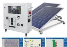
Armoire mobile pour système photovoltaïque et régulateur de charge avec sortie 230V et 12 V
