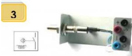
Capteur de proximité M12, détection nominale 2mm,
