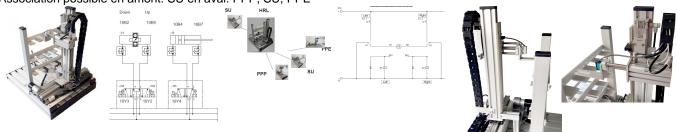
Un axe linéaire électrique avec entraînement par courroie, un axe linéaire dan verin presonatique pour la hauteur ainsi qu'un vérin pneumatique pour les pieces, retirent les pièces d'une étagère et les transportent dans un autre emplacement.
