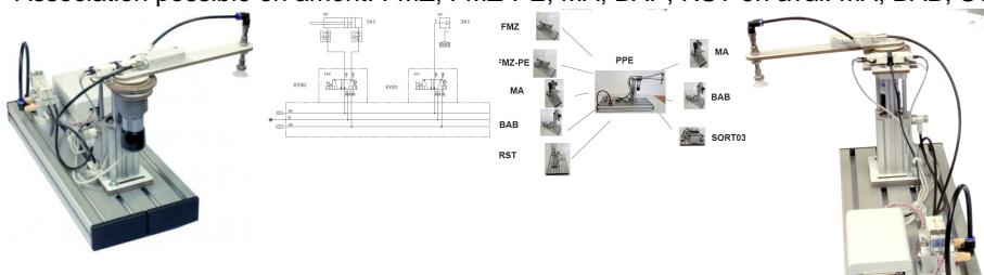
Un moteur à entraînement électrique est soulevé par un vérin à double effet.
