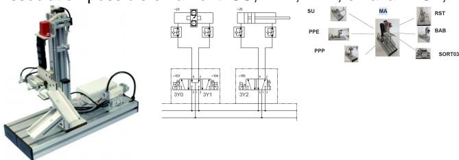
Les pièces sont déplacées sur un porte-pièces avec un dispositif de levage pour venir en buter contre le système de mesure.
