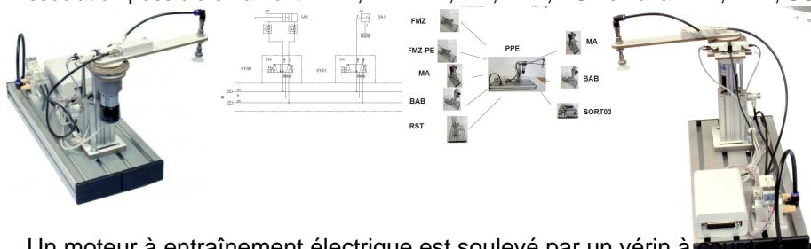
Un moteur à entraînement électrique est soulevé par un vérin à piston à carte.
