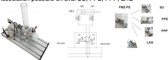
D'un magasin vertical, les pièces à usiner sont séparées et placées sur une plateforme.
