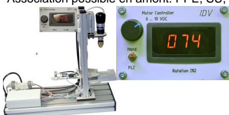
Appareil de perçage électrique à commande pneumatique permettant de transporter, de maintenir et de percer les pièces.
