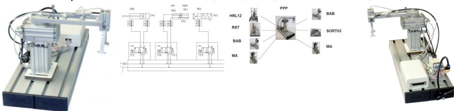
Dispositif de manutention pneumatique avec pièces à usiner prises pneumatiquement, levées et après un mouvement de pivotement jusqu'à max. 180 ° placées à nouveau.
