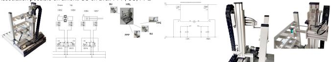
Un axe linéaire électrique avec entraînement par courroie, un axe linéaire dan verin production pour la hauteur ainsi qu'un vérin pneumatique pour les pieces, retirent les pièces d'une étagere et les transportent dans un autre emplacement.
