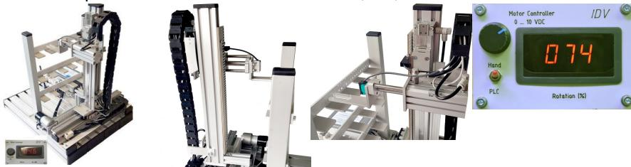
Un axe linéaire électrique avec entraînement par courroie, un axe linéaire par vérin pneumatique pour la hauteur ainsi qu'un vérin pneumatique pour les pièces, retirent les pièces d'une étagère et les transportent dans un autre emplacement.
