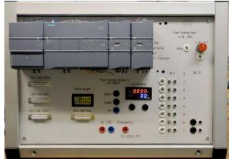
**S7-1215C Automate programmable S7-1215C-PN avec alimentation 24V pouvant piloter 3 PO+1 (MCS-695)**
