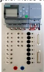
le produit dispose de 12 commutateurs et de 8 LEDs pour la simulation de sortie.
